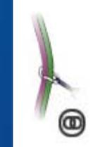
Vérification : état de la gaine sur toute la longueur en remarquant les traces de coupure, d'usure ou de brûlure, état du glissement de la gaine sur l'âme, état de l'âme (en imposant un rayon de courbure régulier et en remarquant les points durs, mous ou les angles marqués), état des nœuds, vérifier la longueur.
